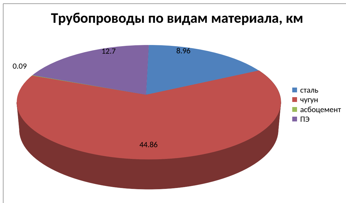
Рисунок 1.4.4.1 - Диаграмма протяженности водоводов по видам материала.
